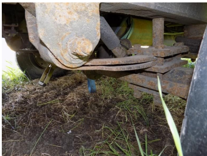
3. Prikolica NIKOS – zadnja osovina – oštećen rukavac
